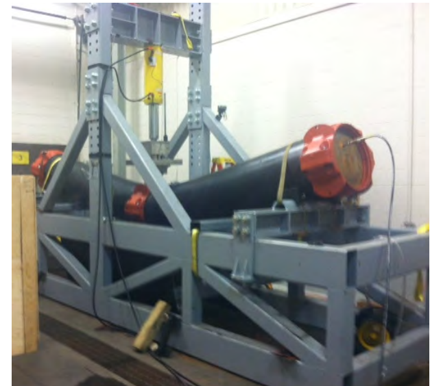
Bend test rig
